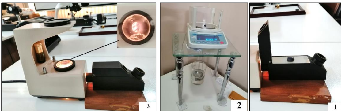
شکل ۸- (۱) بررسی ضریب شکست کیانیت های منطقه با استفاده از رفرکتومتر، (۲) تعیین وزن مخصوص با استفاده از ترازوی هیدرواستاتیک (۳) مشاهده خاصیت انکسار دوگانه (DR) با استفاده از پلاریسکوپ
