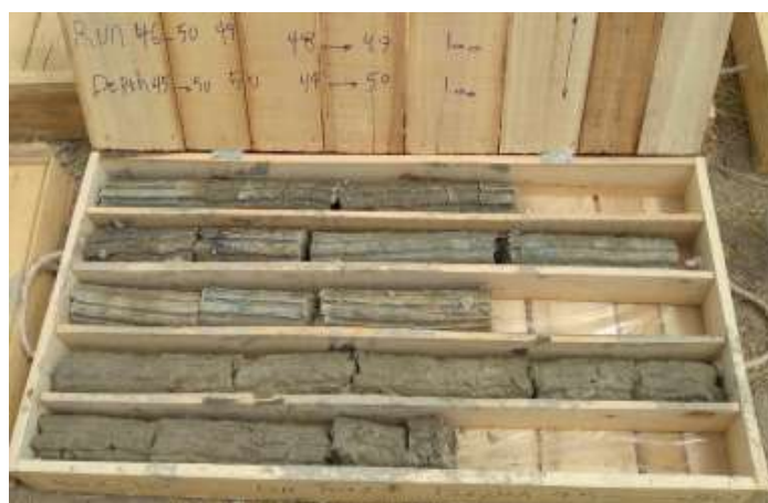
شکل ۴ - تصویری از مغزه های حفاری گمانه (شرکت زمین ژرفاب، ۱۴۰۱)
