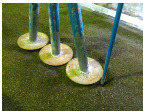
شکل ۱. الف) تصویر آزمایشگاهی گروه پایه کج با شمع حفاظتی ب) گروه پایه کج با طوق و شمع حفاظتی
